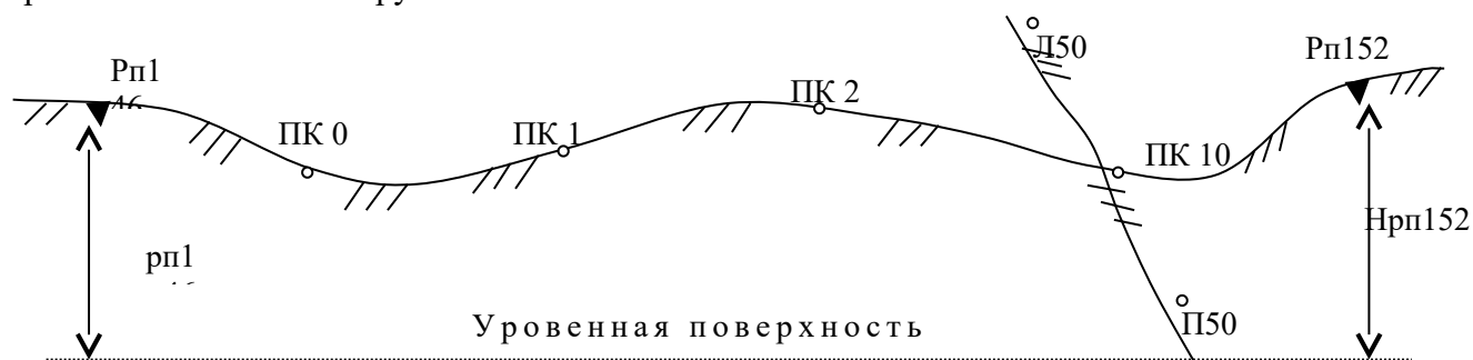
Рисунок 6- Нивелирование трассы и поперечников
